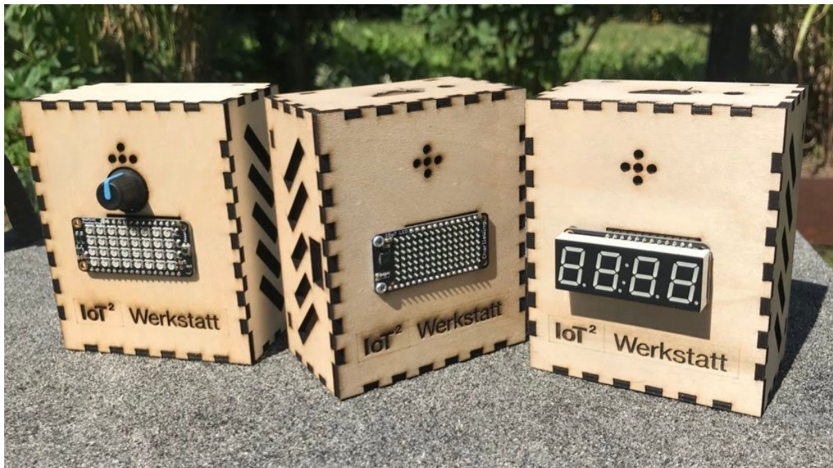
Bild: CO 2 -Ampel zum nachbauen mit unterschiedlichen Anzeigen Ampel, Trend, Zahlen
